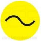
**Wechselstrom:** Stromversorgung mit Wechselstrom
