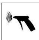
**Druckluft:** Gekennzeichneten Bereich mit Druckluft ausblasen
